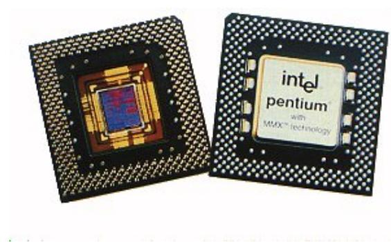
FIG. 2.3: Microprocesseur Intel Pentium
